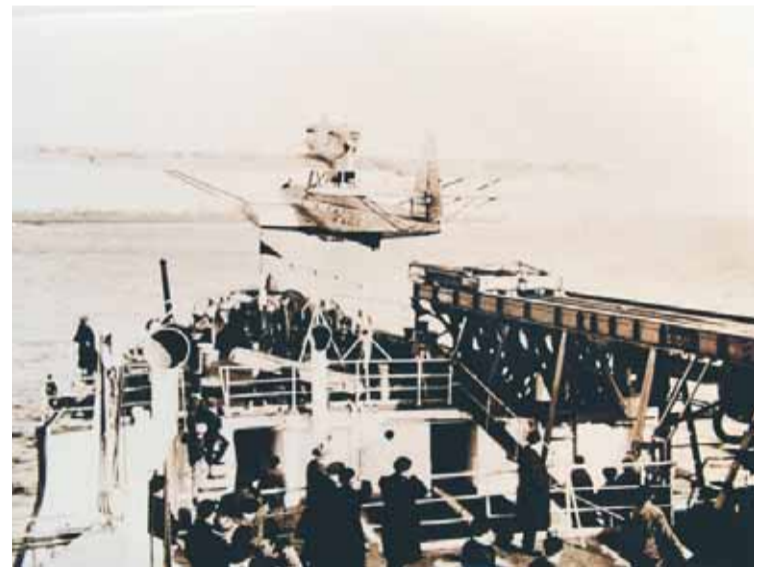
Amfibieflygplan kunde starta från en ramp på däck på S/S Westfalen.
